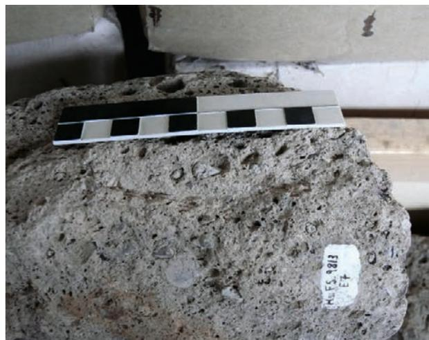
Abb. 3: Werkzeugspuren auf einem Tuffbaustein aus Hollingstedt (Foto: M. Pohl).
