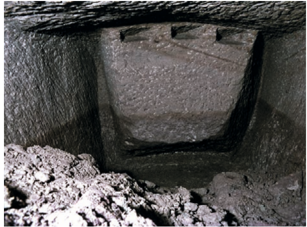
Abb. 2: Vorbereitete Blocklösung in Wallerfangen (Foto: C. Bartels).
