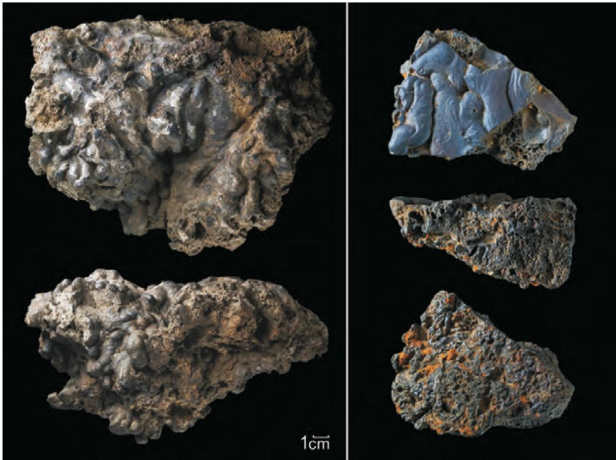
Abb. 33: Diffuse Fließschlacke der eisenzeitlichen Verhüttungsfundstelle „Gerhardsseifen“; Aufsicht sowie Seitenansicht (Links; Fundstelle Projekt-Nr. 324). – Rechts: Abstichschlacke der hochmittelalterlichen Verhüttungsstelle „Buchhellertal“ (Fundstelle Projekt-Nr. 3083); Aufsicht, Seitenansicht u. Untenansicht (Fotos: LWL-Archäologie für Westfalen/H. Menne u. T. Poggel).
