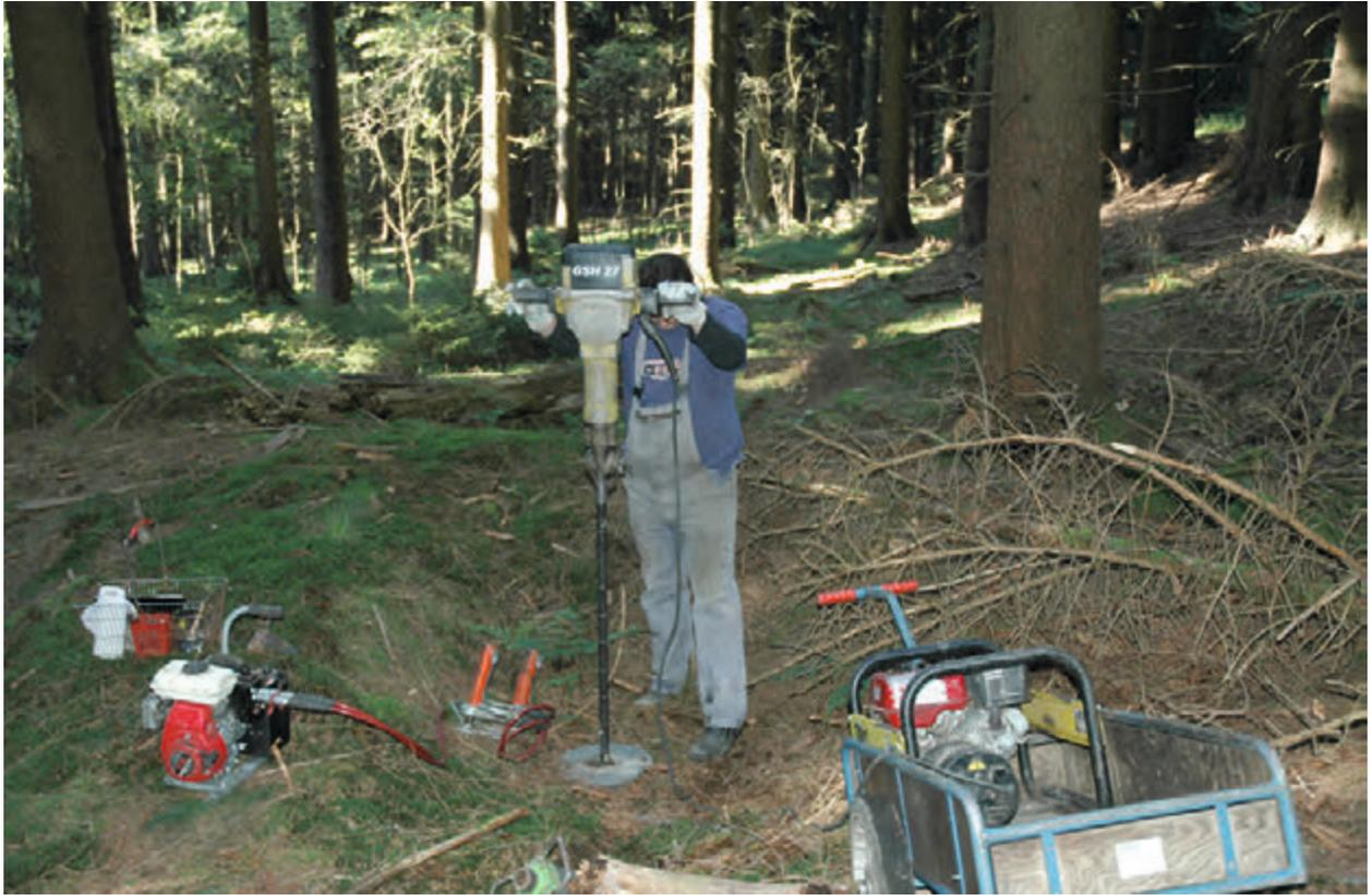
Abb. 38: Rammkernbohrung in einer Pingenvorfüllung 2007 (Foto: Deutsches Bergbau-Museum Bochum/B. Sikorski).
