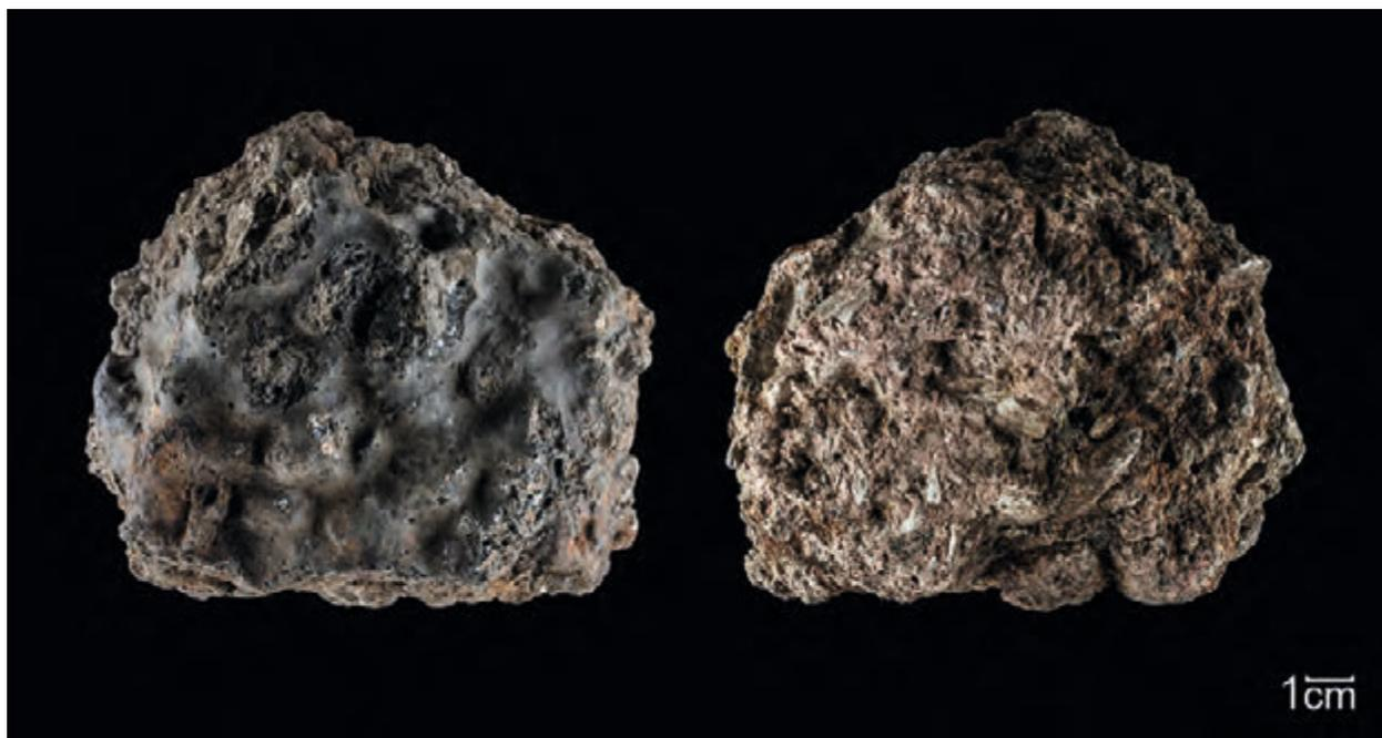
Abb. 35: Beispiel einer eisenzeitlichen Ofenwand (Verhüttungsfundstelle Fundstelle Projekt-Nr. 324); Innenseite links u. Außenseite rechts mit erkennbaren weiß gesprenkelten Mullit-Einschlüssen (Foto: LWL-Archäologie für Westfalen/H. Menne).
