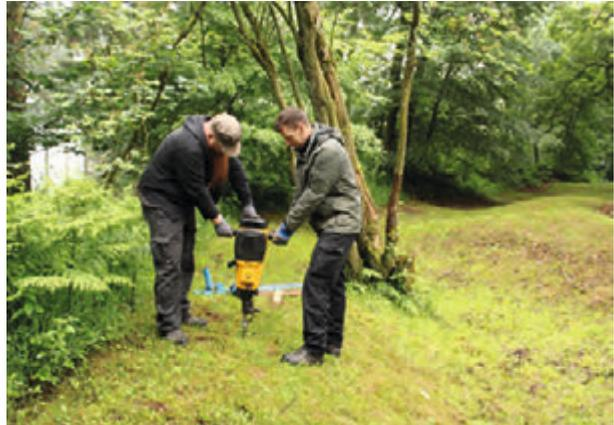
Abb. 109, Kat.-Nr. 397: Fundstelle Projekt-Nr. 2329: Rammkernbohrung im Walkkörper (Foto: LWL-Archäologie für Westfalen/M. Zeiler).
