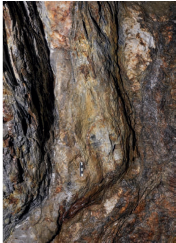
Abb. 364: Umlaufend freigestellter und somit zum Abkeilen vorbereiteter Block im Erzgang an Fundstelle 4670 (Blickrichtung: West-Nordwest; Länge des Maßstabs: 5 cm Foto: DBM).
