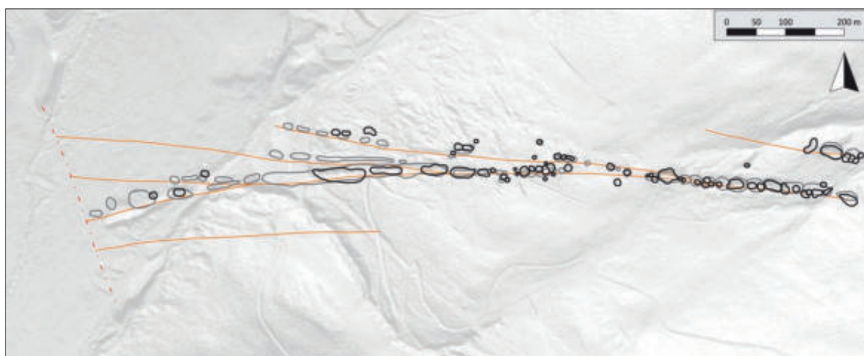
Abb. 193: Die Pingenzüge des Mitterberger Hauptgangs auf Grundlage älterer Kartierungen sowie neu erhobener LIDAR-Daten: schwarz – Pingenzüge nach LIDAR-Daten; grau – Pingenzüge nach Pirchl, 1855 sowie nach Zschocke und Preuschen, 1932; gelb – Erzgänge (Ausschnitt wie Abb. 192; zu den Erzgängen siehe: Abb. 197).
