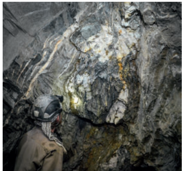
Abb. 15: Erzgang im Arthurstollen. Das Erz wie auch der quarzführende Gang sind stark mit dem Schiefer des Nebengesteins verwachsen (Foto: M. Dehling).
