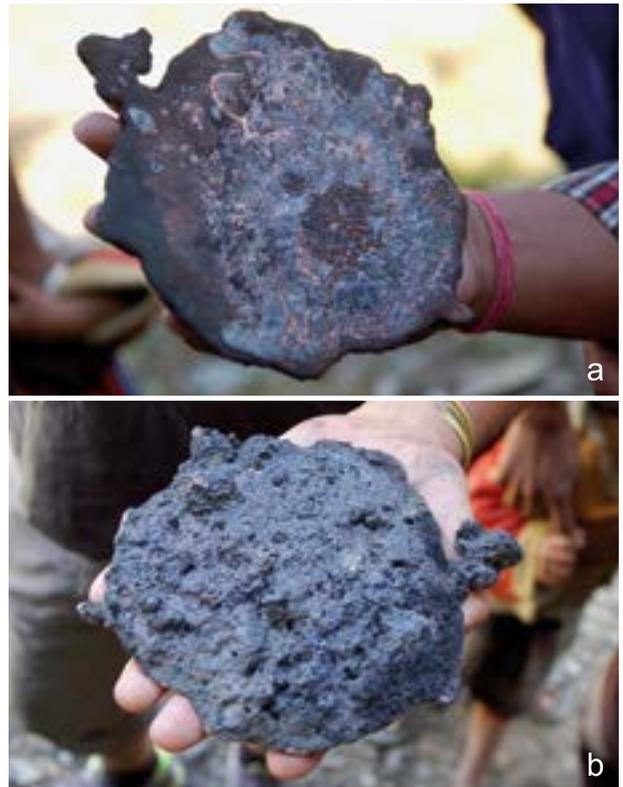
Abb. 5.8: Das Endprodukt aus dem zweiten Schmelzgang, das metallische Kupfer von oben (a) und von unten (b). Foto: N. Anfinset, Universität Bergen.
