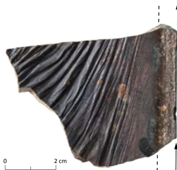
Abb. 3.15: Detailansicht der Unterseite eines Plattenschlackenfragments mit einem partiell erhaltenen Werkzeugnegativ (gestrichelt). Seitlich des Abdrucks haben sich – ähnlich dem Wellenschlag entlang einer Bootsfahrspur – Runzeln gebildet, die unverkennbar die Stoßrichtung des Werkzeugs (Pfeil) anzeigen. Foto: G. Perissinotto, ADG; L. Reitmaier-Naef, UZH.
