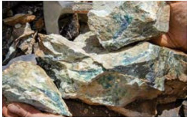
Abb. 2.19: Marmorera, Cotschens. Frisch aufgeschlagenes Handstück aus dem Bereich der Vererzung Cotschens 2, Marmorera. Das helle Nebengestein (Diabasgang/Metabasalt) und die Kupfersekundärminerale sind gut erkennbar. Das Erz selbst zeigt die für Vererzungen bornitischer Zusammensetzung typische violette Farbe. Foto: L. Reitmaier-Naef, UZH.
