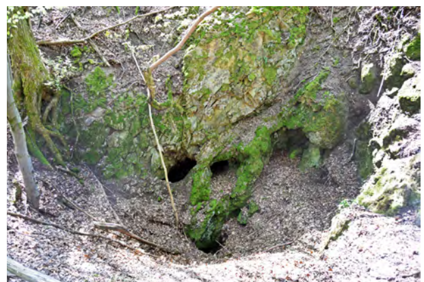
Abb. 29 und 30: Fundstelle 220. Zu erkennen ist ein Tagesbruch von etwas 20x20 m Dm. In einer Tiefe von etwa 10 m sind Strecken zu erkennen, die weiter in den Berg führen (Foto: Deutsches Bergbau-Museum Bochum/D. Demant).
