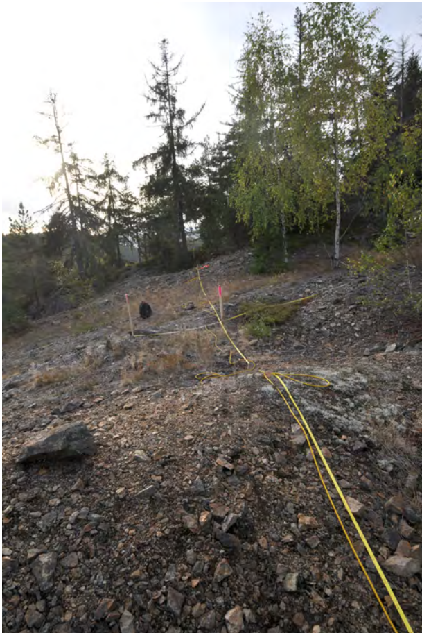
Abb. 90: Verlauf und Absteckung eines der geoelektrischen Profile im Gelände (Foto: Deutsches Bergbau-Museum Bochum/ D. Modarressi-Tehrani).
