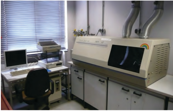
Abb. 85: Das Gerät vom Typ IRIS/AP-HR der Firma Thermo Jarrell Ash im Forschungslabor des Deutschen Bergbau-Museum Bochum (Foto: Deutsches Bergbau-Museum Bochum/M. Prange).
