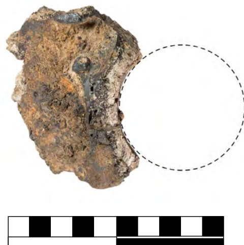
Abb. 68: Trüllesseifen, Düsenöffnung Fd.-Nr. 22, verschlackte Innenansicht (Foto: Deutsches Bergbau-Museum Bochum/J. Garner).
