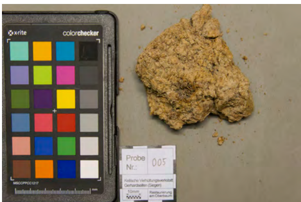
Abb. 185: Test zur Konsolidierung entfestigter Steine (Foto: Restaurierung am Oberbaum).
