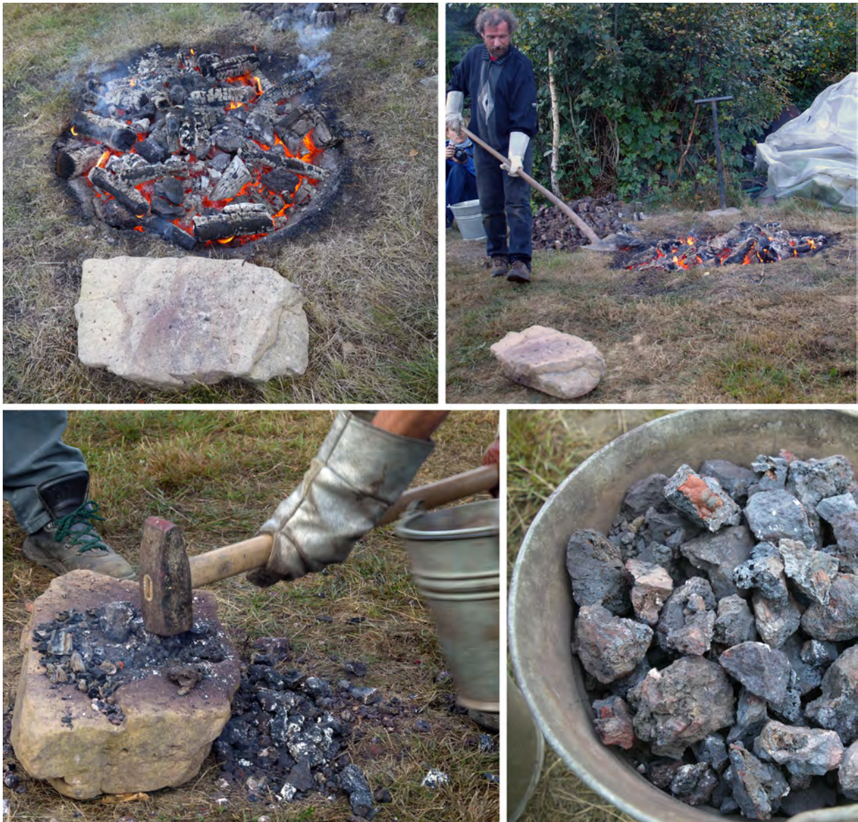
Abb. 123: Experiment zum Erzrösten im Hauberg des Heimat- und Geschichtsvereins Offdilln e.V. 2009. Links oben: Röstgrube und Pochstein. – Rechts oben: Glühende Erzbrocken werden von der Röstgrube auf den Ambossstein gebracht. – Unten links: Pochen der Erze. – Unten rechts: händisch ausgelesene Erze nach dem Pochen (LWL-Archäologie für Westfalen/E. Cichy, R. Fahr u. A. Eichler).
