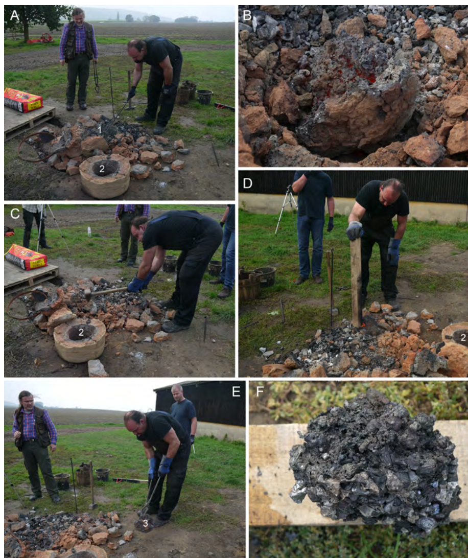
Abb. 117: Rennfeuerverhüttung im Schachtofen mit Schlackenabstich in der „Seelenschmiede“ des Waffenschmiedes Stefan Roth bei Braunschweig im September 2014. Zum Zeitpunkt dieser Fotos ist die Ofenreise beendet worden und der Ofen wurde bereits aufgeschlagen. Die Ofenbasis (1) ist umgeben von zerschlagenen Ofenwandfragmenten, nur die Gichtöffnung (2) blieb in einem Stück erhalten. Zunächst wurde die Ofensau (B: Dm. ca. 35 cm) mittels Eisenhaken gelockert (A), mit Wasser abgeschreckt (hier nicht im Foto dargestellt) und dann von ihr die Luppe mittels Setzhammer (C) sowie Kantholz (D) abgetrennt. Mit einer Zange wurde sie herausgezogen (E) und danach auch kleinere Luppenbruchstücke (F: Dm. 11 cm) geborgen, um sie in der benachbarten Schmiede zu reinigen (Fotos: Deutsches Bergbau-Museum Bochum/J. Garner u. LWL-Archäologie für Westfalen/M. Zeiler).
