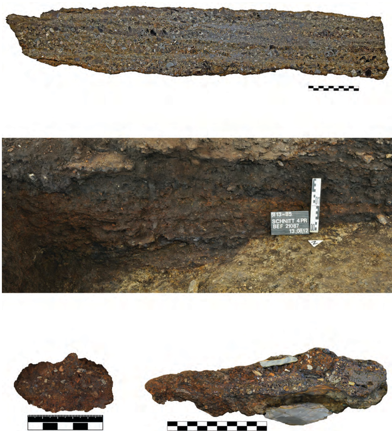
Abb. 102: Makroskopischer Vergleich der drei Schlackenbreccien untereinander. Oben: Trüllesseifen. Mitte: Gerhardsseifen. Unten: Minnerbach (links: 6035; rechts: 6100) (Foto: Deutsches Bergbau-Museum Bochum/D. Demant und C. Wirth, digitale Bearbeitung: D. Demant).
