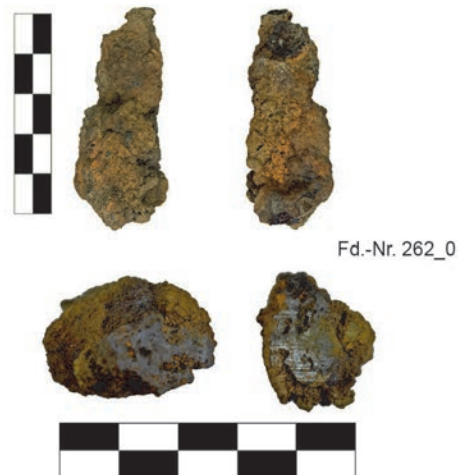
Abb. 14 Dutenbach, Fundstelle 225. Lupenschlacke. Oben: Seitenansichten. Unten: Schnitt durch das Lupenstück zeigt auf der rechten Hälfte nicht ausgebrachte Eisen. Foto: S. Menic, RUB.
