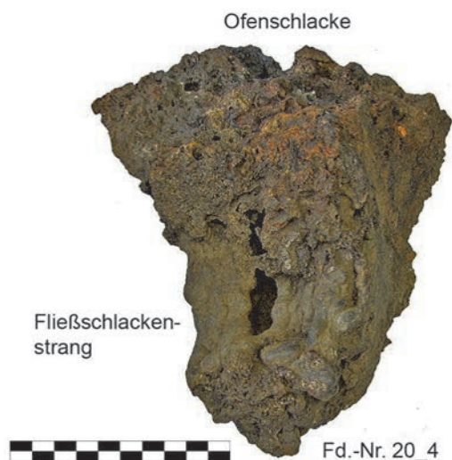
Abb. 5 Trüllesseifen, Fundstelle 127. Fließschlackenstück mit anhaftender Ofenschlacke. Auf der Außenseite liegend fotografiert. Foto: S. Menic, RUB.
