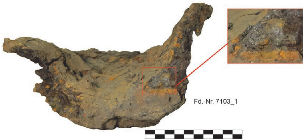
Abb. 68 Leimbach, Fundstelle 193. Eine typische Ofenschlacke der Grabung Weisgerber/Schardt. Der Detailschnitt zeigt Eisenflimmer. Vermutlich handelt es sich um das Produkt eines fehlgeschlagenen bzw. nicht optimal gesteuerten Verhüttungsprozesses. Foto: S. Menic, RUB.
