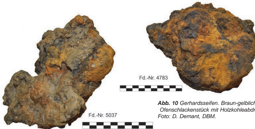
Abb. 9 Gerhardsseifen. Orientierbares Verhüttungsschlackenkonglomerat. Graue Fließschlacke im Herabfließen erstarrt. Daran oberhalb anhaftend Reste der braun-gelblichen Ofenschlacke. Foto: D. Demant, DBM.
