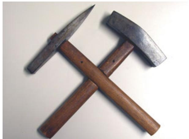
Abb. 11: Schlägel (rechts) und Eisen (links), Montanhistorisches Dokumentationszentrum (montan.dok) beim Deutsches Bergbau-Museum Bochum 030012096000 und 030120104000 (Foto: montan.dok /M. Ganzelewski).
