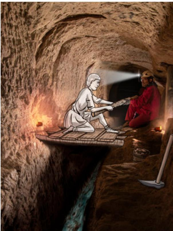
Abb. 228: Rekonstruktion der Bühne über der Wasserseige auf Höhe des Abbauraums (Foto: Deutsches Bergbau-Museum Bochum/G. Steffens, Visualisierung: D. Relic, 2022).
