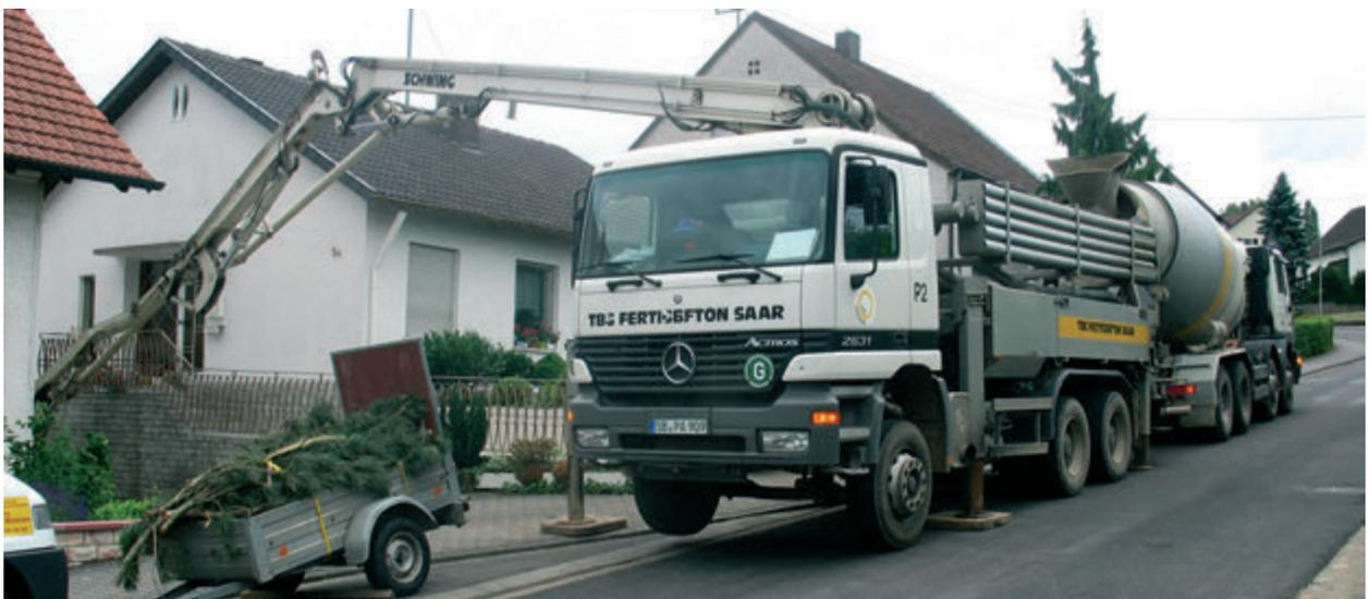
Abb. 271: Der dünnflüssige Beton wird über Rohre vom Betonmischer zur Baustelle geleitet (Foto: Deutsches Bergbau-Museum Bochum/S. Müller).
