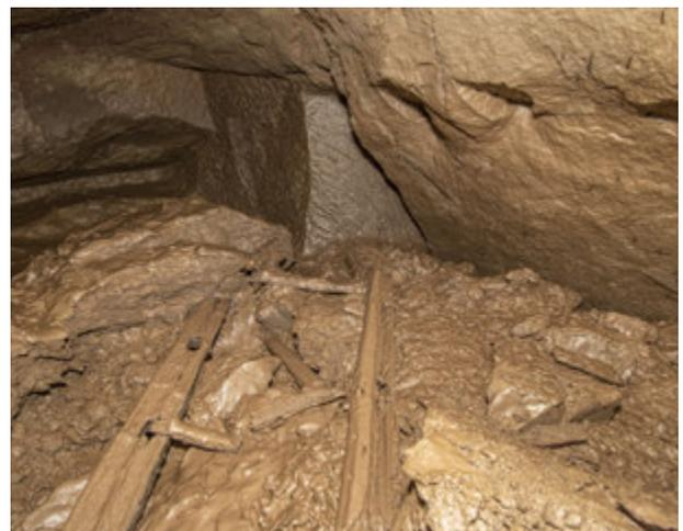
Abb. 153: Blick über einen Teil der Fahrte in den hinteren Bereich der Suchstrecke, 2022. Sowohl am rechten Stoß als auch an der Arbeitsfront wurden Vorbereitungen für das Abkeilen weiterer Blöcke getroffen (Foto: Deutsches Bergbau-Museum Bochum/G. Steffens).
