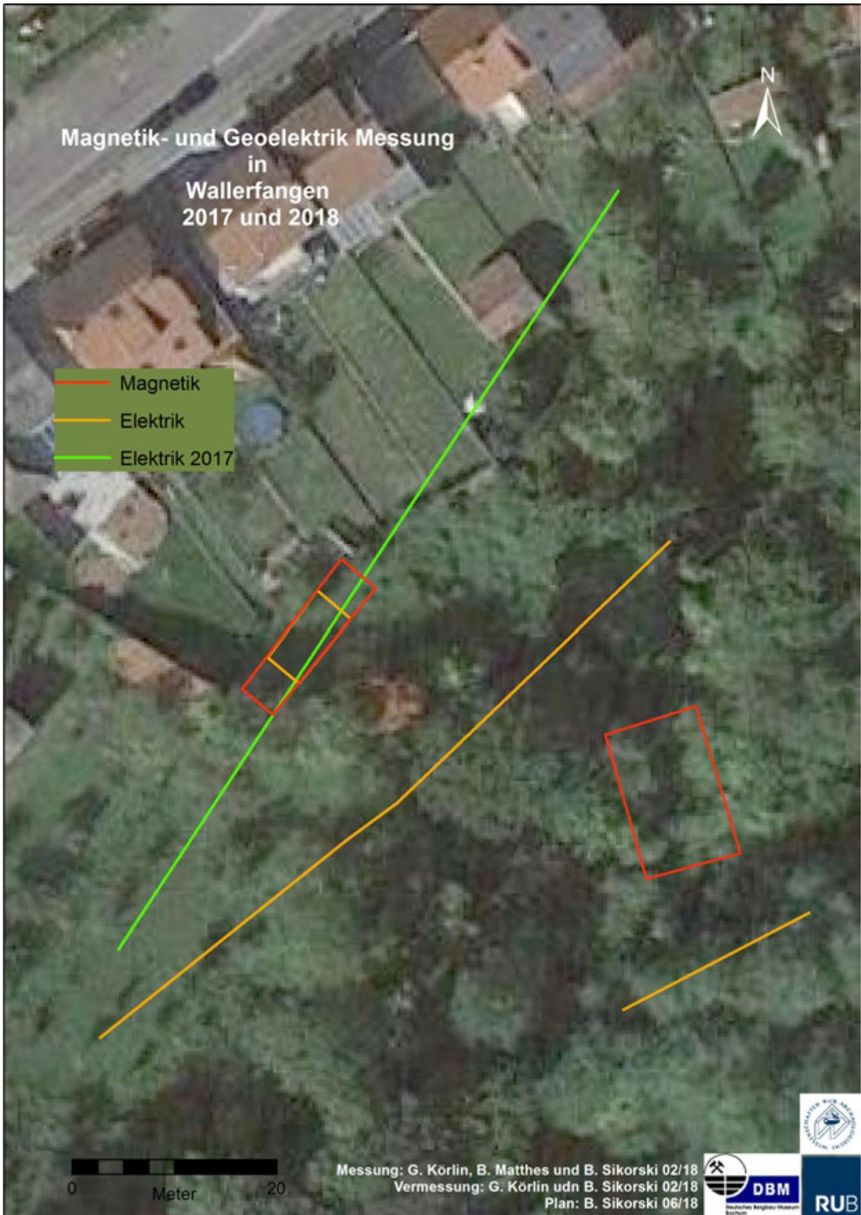
Abb. 276: Überblick über die 2015 und 2018 durchgeführten geomagnetischen und geoelektrischen Messungen im Bereich des Stollens Bruss (Plan: Deutsches Bergbau-Museum Bochum/B. Sikorski).
